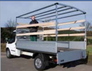
Einbau der Einstecklatten
